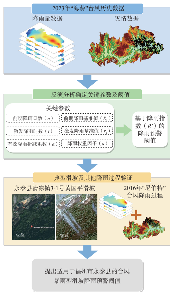
图8 降雨预警阈值分析验证流程图
