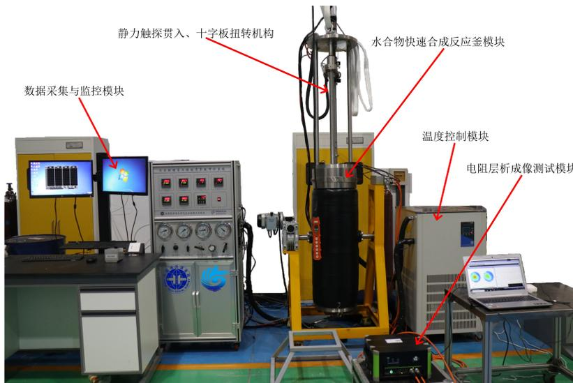
图2 天然气水合物工程地质参数评价系统实物照片
