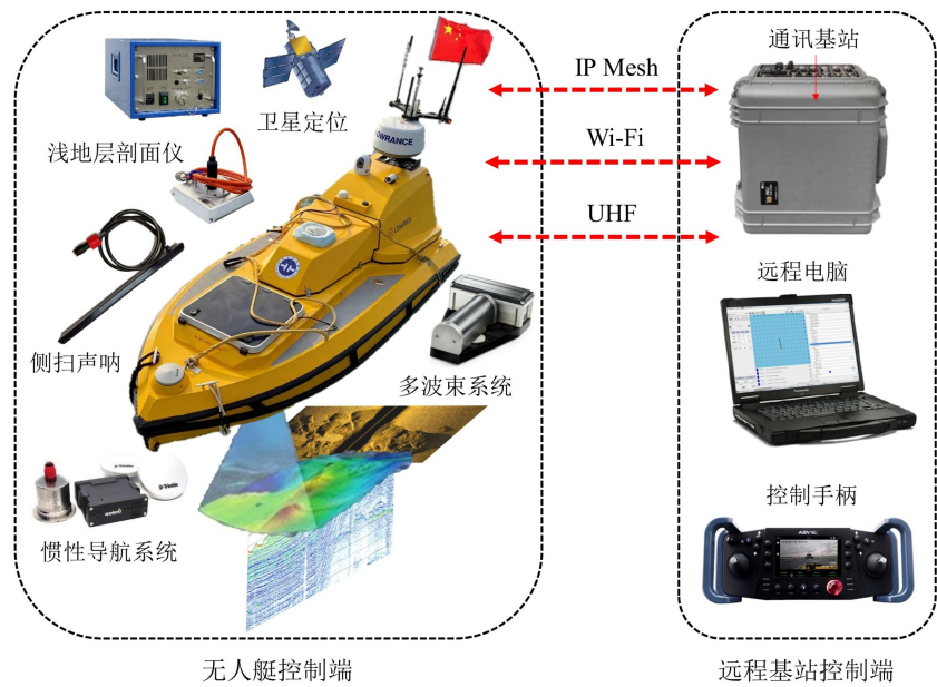
图 1 声学水面无人艇主要组成示意图 Fig.1 Main components of acoustic USV
