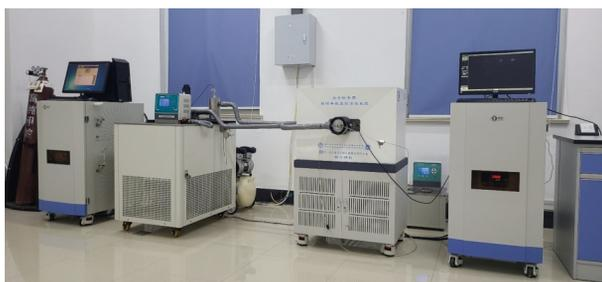
图 1 水合物专用低场核磁共振测试装置照片
