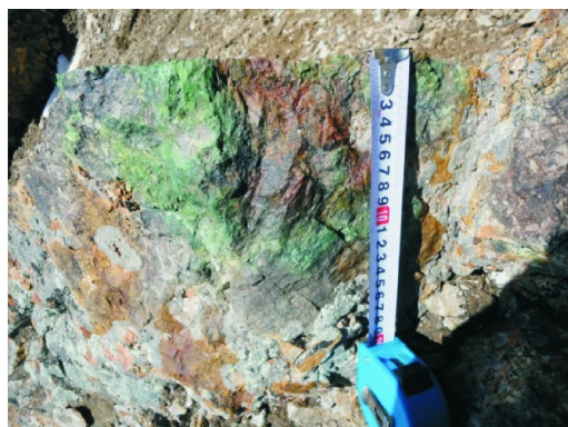
图6 5484高地铜矿石中次生的孔雀石及褐铁矿
