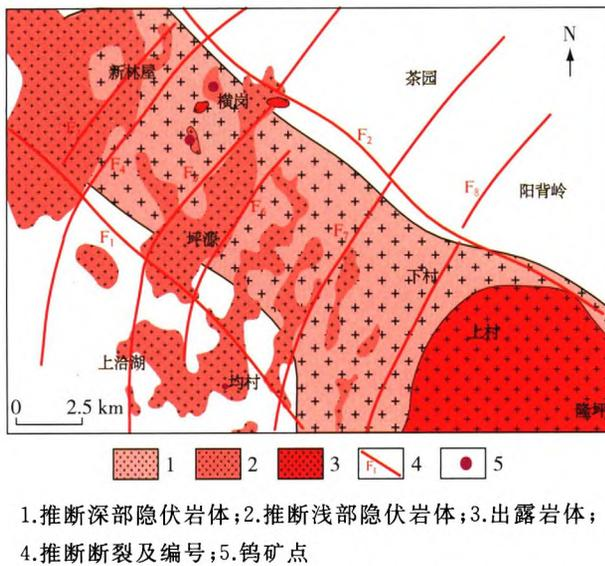
图 5 推断隐伏岩体及断裂分布图
