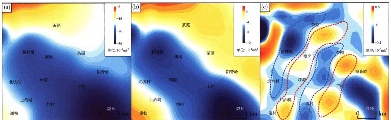
图2 1:20万布格重力异常图(a)、剩余重力异常图(b)及三阶细节异常图(c)
