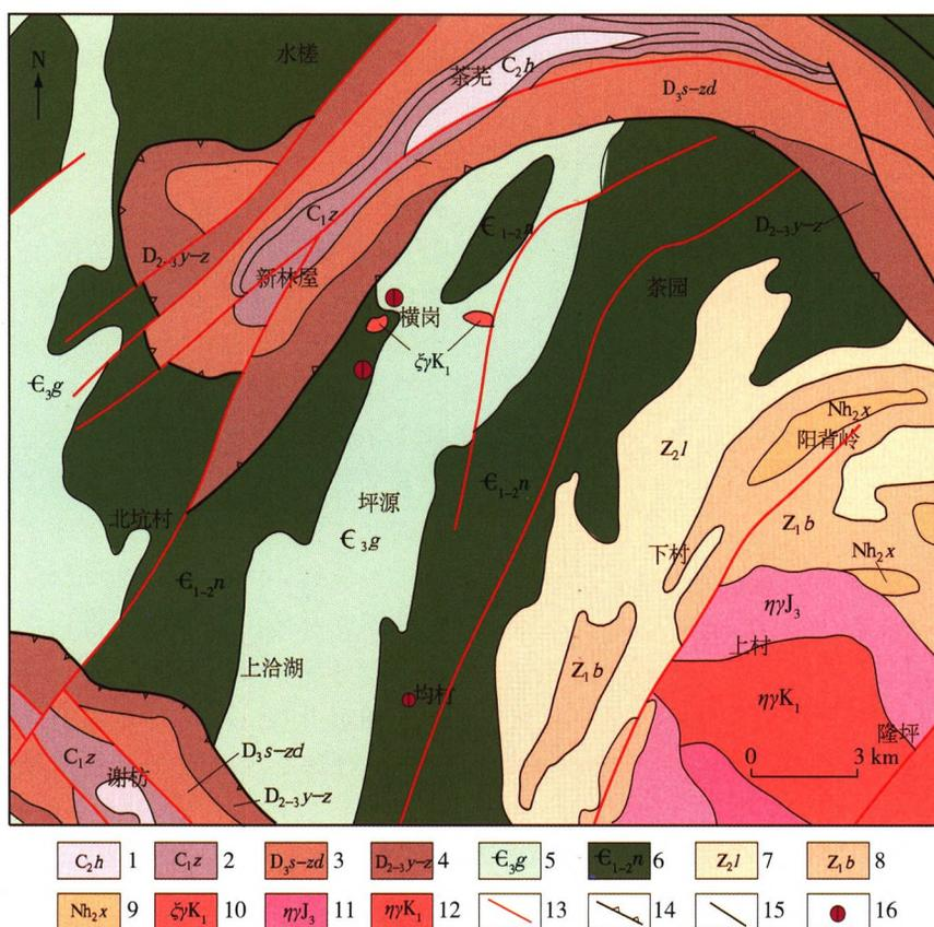
1. 黄龙组;2. 梓山组;3. 三门滩组—樟崇组;4. 云山组—中棚组;5. 高滩组;6. 牛角滩组;7. 老虎塘组;8. 坝里组;9. 下坊组;10. 正长花岗岩;11. 斑斑黑云母二长花岗岩;12. 含斑黑云母二长花岗岩;13. 断裂;14. 滑脱断裂;15. 地质界线;16. 钨矿点
