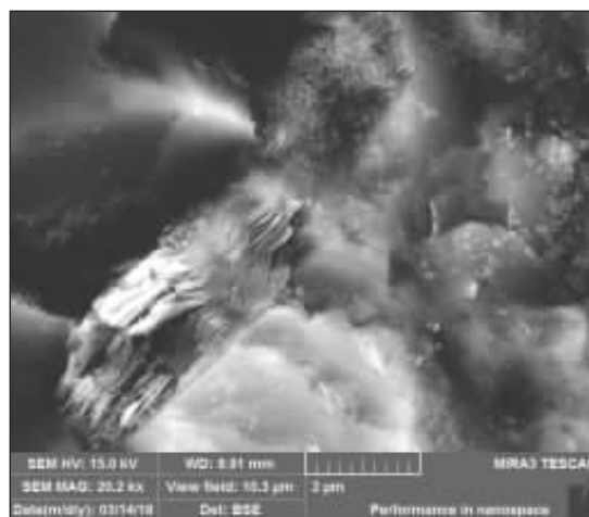
图 4 砚石扫描电镜下白云母显微照片
