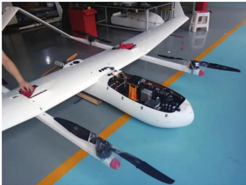
搭载于无人机的小型机载高光谱成像系统
