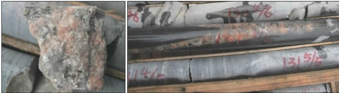
图6 ZK001钻孔中的花岗伟晶岩脉照片
