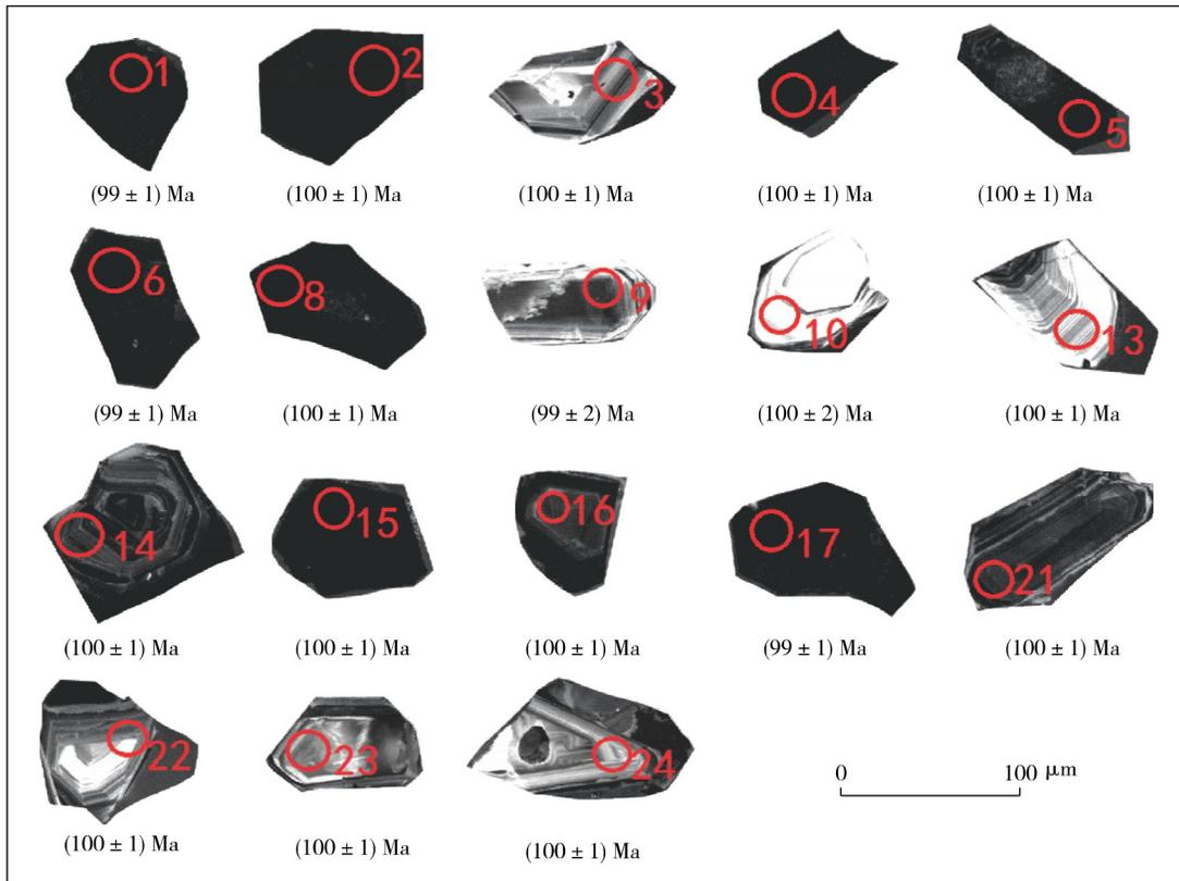
图 4 银坑安山玢岩锆石 CL 图像
