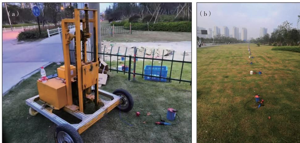
图7 风起线反射与折射地震夯源(a)和节点式地震记录仪采集排列(b)
