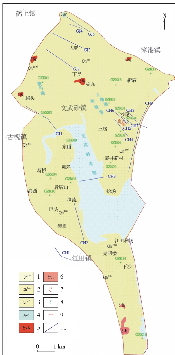
1.全新统上段风积层; 2.全新统中段冲洪积层; 3.全新统中段海积层; 4.上侏罗统南园组第二段; 5.早白垩世正长花岗岩; 6.晚侏罗世正长花岗岩; 7.滨海新城核心区范围; 8.已知钻孔; 9.验证钻孔; 10.微动测量剖面
