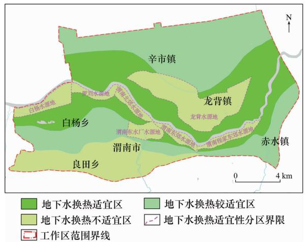
图 5 渭南市浅层地热能地下水适宜性分区
