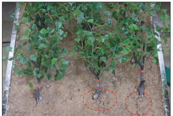
图9 10~12 号树根部裂缝分布
