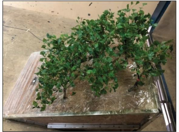
图8 第 4 组实验后植被模型倾倒状况
