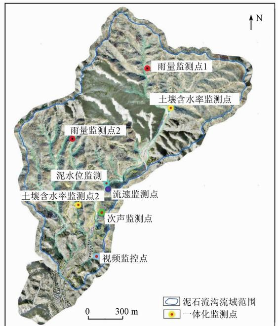
图 5 小梁后沟印子峪泥石流沟专业监测设备位置
