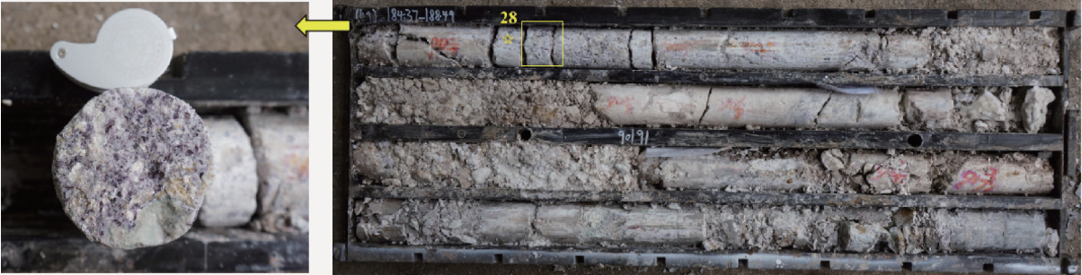
图 1 四川省冕宁龙家沟 ZK001 钻孔揭露的含氟碳铈矿 - 萤石 - 重晶石 - 方解石矿石照片 (2023 年 8 月) Fig. 1 Photographs of bastnaesite - fluorite - barite - calcite ores in drilling bore ZK001 in Longjiagou of Mianning in Sichuan Province (August, 2023)
