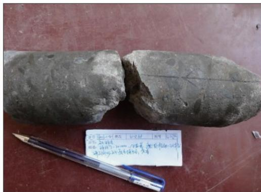
(d) X-2 井,4 106 m(砂砾岩段,致密岩性段与孔隙发育段相邻,非均质性强)
