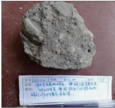
(a) X-2 井,4 103.2 m(砂砾岩,含有较多的白云质及生物碎屑,孔隙发育)
