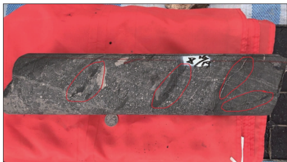
图5 黔水地1井斜裂缝岩心照片
