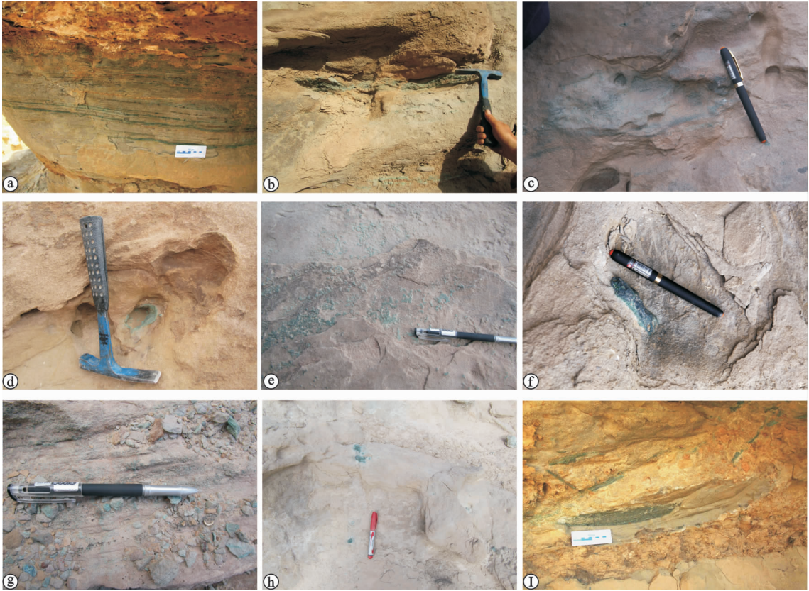
a. 层状构造;b. 条带状构造;c. 浸染状构造;d. 团块状构造;e. 薄膜状构造;f. 柱状构造;g. 星点状构造;h. 结核状构造; i. 细脉状构造
