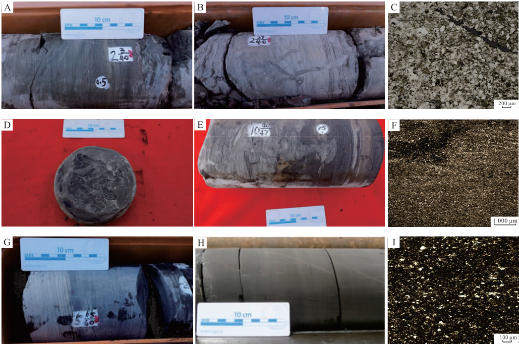
A. 波状交错层理;B. 虫迹;C. 贫有机质块状硅质泥岩相;D. 植物碳屑;E. 钙质团块、变形构造; F. 贫有机质块状黏土质泥岩相;G. 水平层理;H. 碳质页岩;I. 富有机质块状黏土质泥岩相
