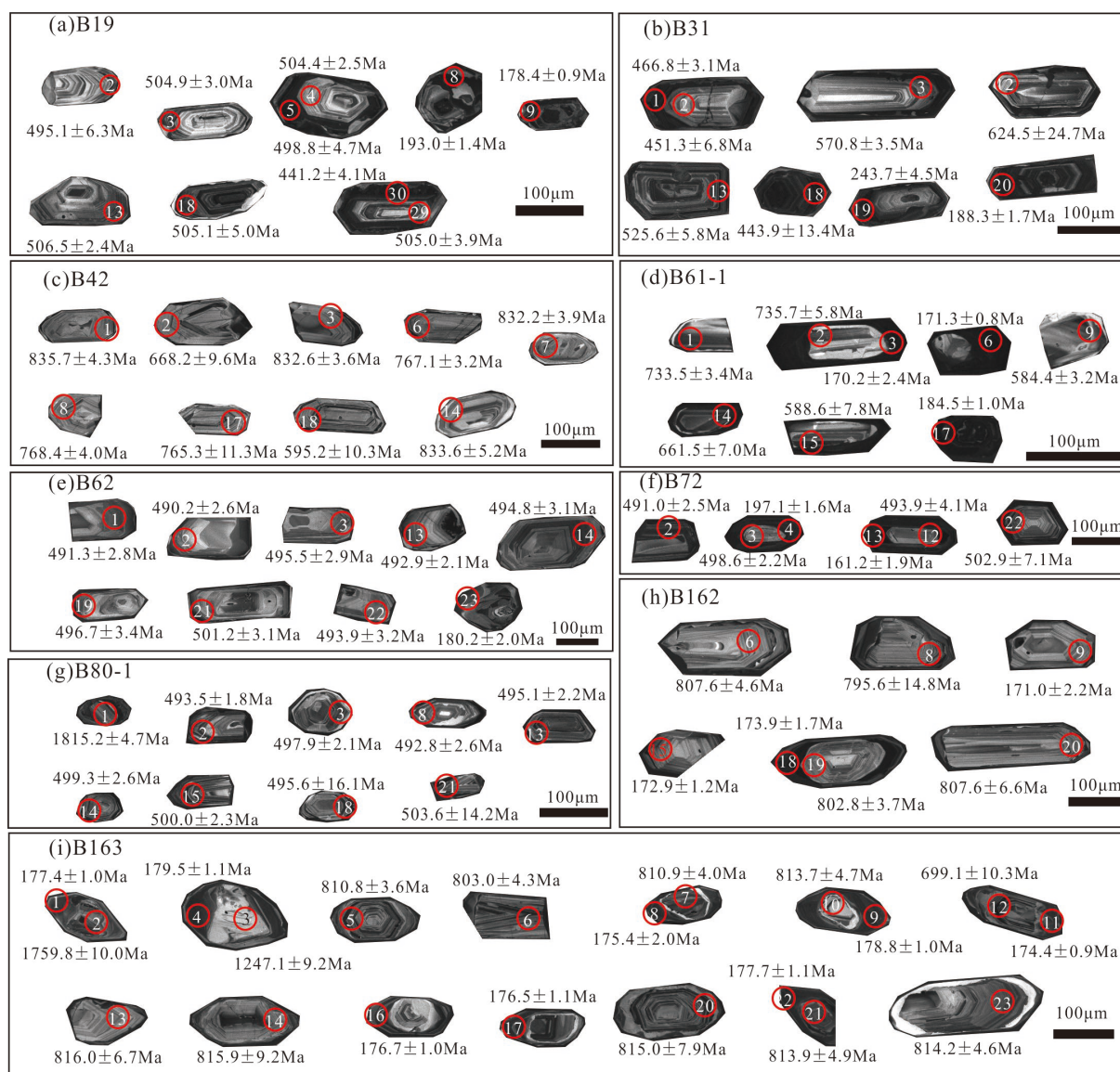
图3 聂荣微陆块片麻岩锆石阴极发光图像
