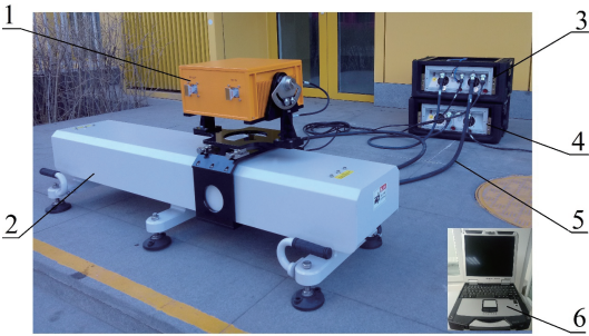
图 2 S-SAR-I 型边坡雷达系统组成 Fig. 2 System composition of S-SAR-I
