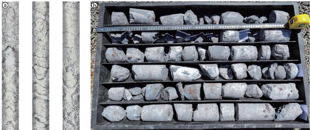
图 10 ZK02 孔内电视成像 (a) 和;ZK02 钻孔岩芯照片 (b)
