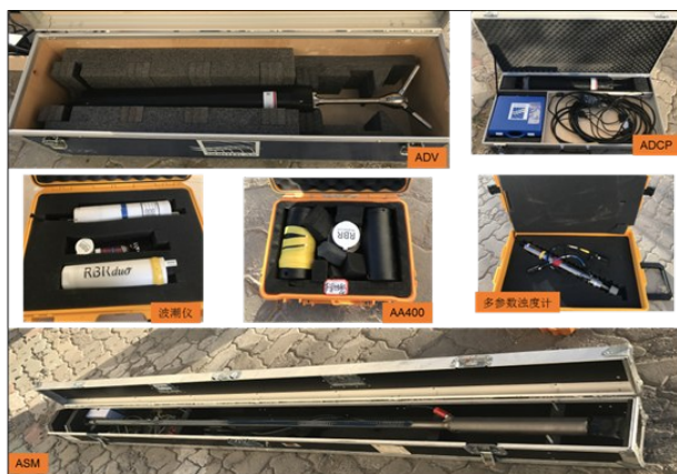
图7 临时原位观测平台搭载的仪器设备
