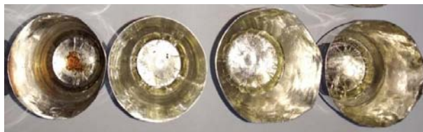
图1 GBW07157在不同熔样温度下的分解效果
