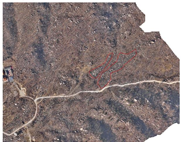
图11 利用无人机获取的影像分析得到的物源区
