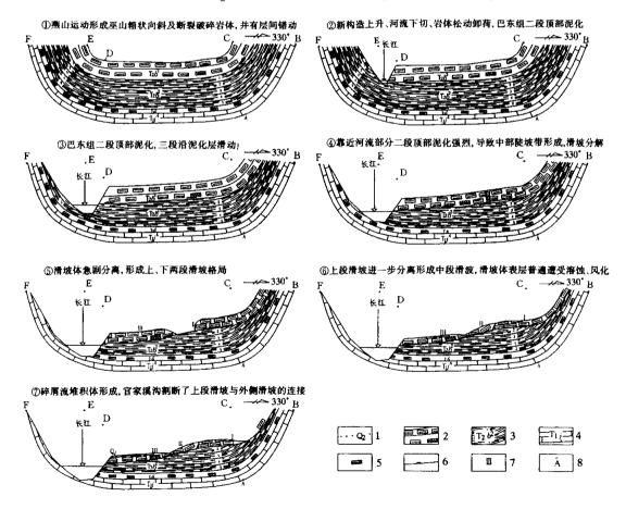
图 2 巫山县新城址巴东组三段滑坡过程示意图
