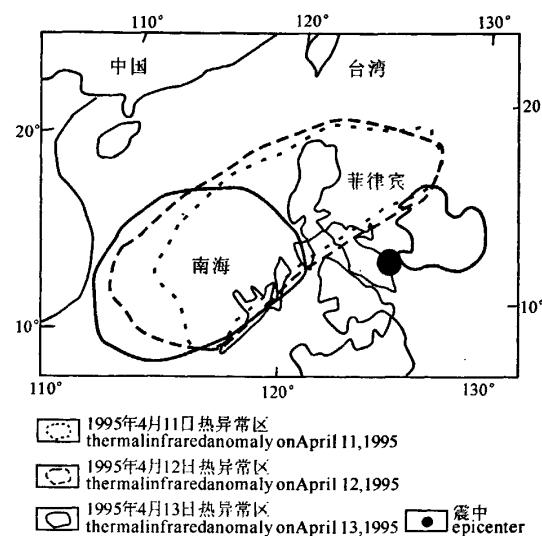
图3 菲律宾萨马岛卫星热红外升温椭圆环推进路径
