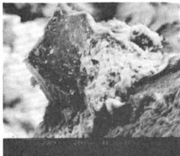
图7 尾矿颗粒被地质聚合物胶结的SEM照片 (A-尾矿颗粒;B,C-非晶态地质聚合物胶凝相)
