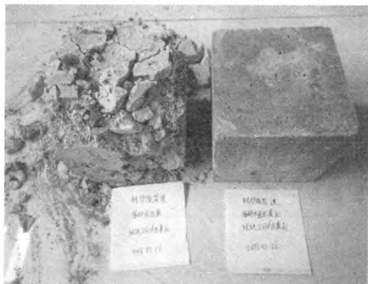
图4 转炉钢渣混凝土砌块养护 28d 后的安定性情况
