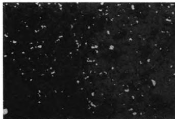
b 黄铁矿呈星散浸染状嵌布(反射光:100X)
