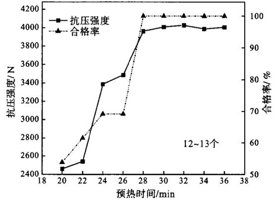
图12 粒径12~14 mm球团焙烧强度
