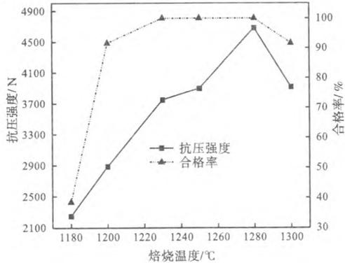
图 8 预热 30min 时焙烧温度的影响
