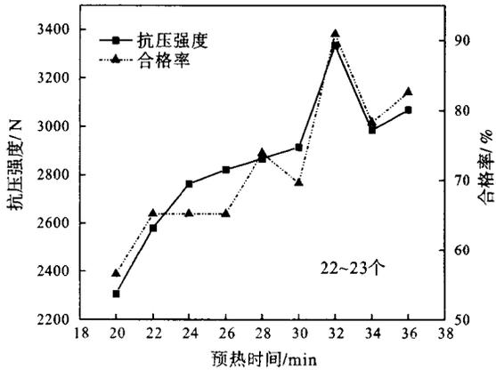
图10 粒径8~10 mm球团焙烧强度
