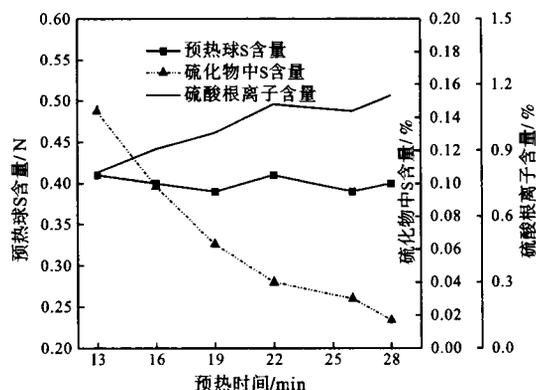
图 2 预热时间对预热球中 S 含量的影响
