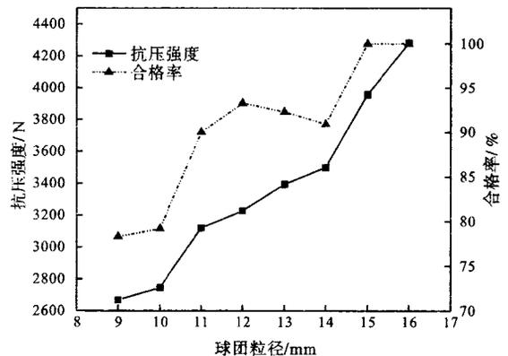
图14 不同粒径球团鼓风预热焙烧结果
