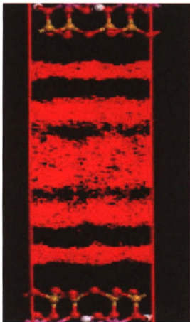
图2 高岭石 2 nm 孔径 1 km 埋深的吸附
