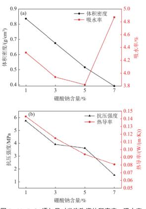
图 7  $Na_2B_2O_7$  添加量对发泡陶瓷体积密度、吸水率(a)抗压强度、导热系数 (b) 的影响 Fig.7 Effect of  $Na_2B_2O_7$  addition on the bulk density, water
