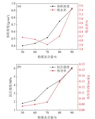
图 3 粉煤灰含量对发泡陶瓷体积密度、吸水率(a)抗 压强度、导热系数(b)的影响
