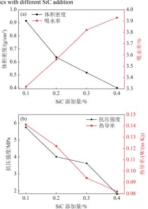
2.2 SiC 添加量对发泡陶瓷性能及气泡结构的
