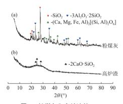
图 1 粉煤灰和高炉渣的 XRD
