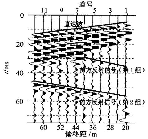
图 8 圆梁山隧道出口开挖部分预报记录
