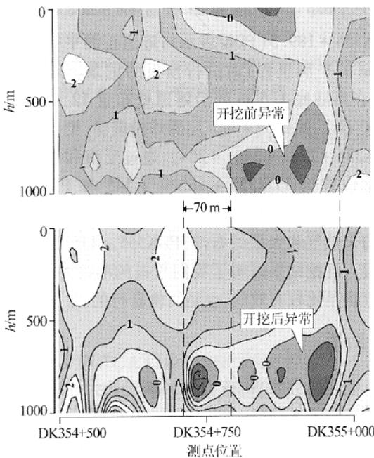
图 6 DK354+879 岩溶开挖前后  $\rho_s$  断面对比
