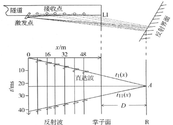
图 7 负视速度地震反射波法工作原理
