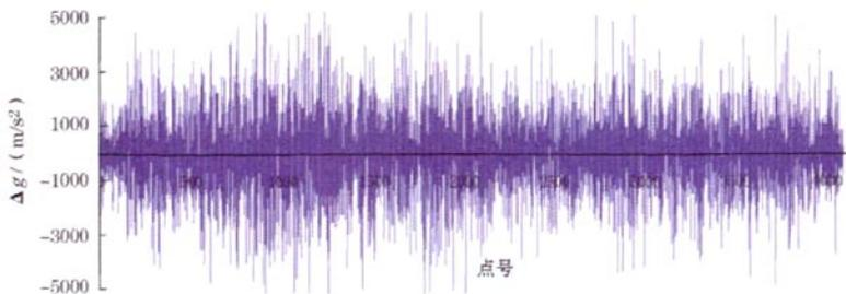
图1 GT-1A 型航空重力系统原始未滤波自由空气重力测线数据
