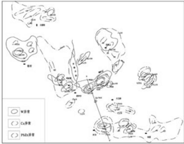
图 2 东乡铜矿及外围 Cu、Pb、Zn、W 异常分布图
