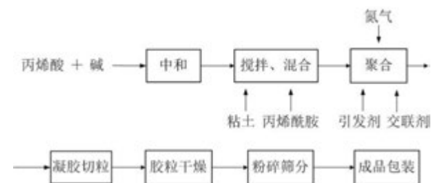
图2 粘土复合保水剂的制备流程简图
