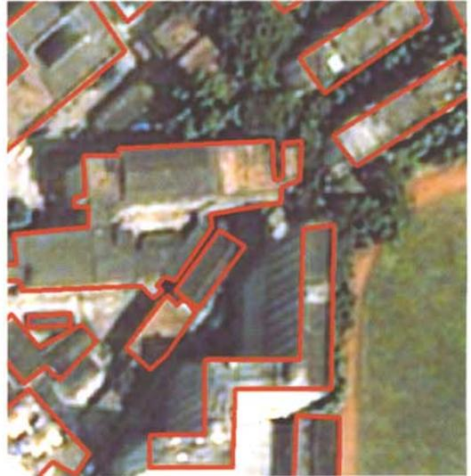
彩片11 红色实线为实验所采集的建筑物外型数据示意图
