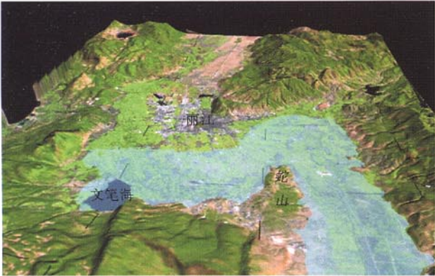
a 丽江盆地 VirtualGIS 视景叠加洪水层 (ETM 图像为表层纹理, 浅蓝色为洪水层, 洪水水位 2 381 m)
