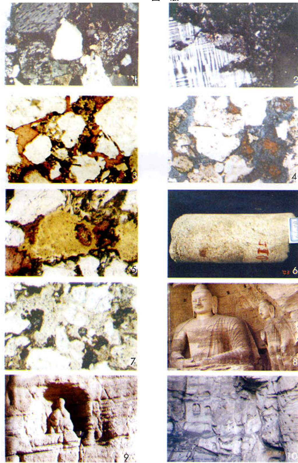
图版说明：1. 岩屑砂岩中的石英岩岩屑(A)、白云母石英片岩岩屑(B)、石英(Q)等(3窟主室东壁,正交光,×40);2. 长石质岩屑砂岩中的微斜长石碎屑(M)等(3窟内1号平硐口西侧,正交光,×100);3. 含铁方解石(紫红色)充填碎屑颗粒(F)间孔隙(7号孔,12.60m;单偏光,×40);4. 含铁方解石(紫红色)与含铁白云石(淡蓝色)一起充填碎屑颗粒(F)间孔隙(7号孔,22.20m;单偏光,×40);5. 碎屑颗粒(F)间含铁方解石(紫红色)部分溶解后形成孔隙(P)和铁锈色残留边;其未溶解部分呈悬浮状、残留边状(1号孔,27.99m;单偏光,×100);6. 碳酸盐胶结物风化后在岩芯上呈现的密集铁锈色斑点(3号孔,31.46m);7. 含铁白云石(淡蓝色)风化后形成丰富的铁锈色物质(2、3窟间崖壁表面;单偏光,×40);8. 石雕表面因水溶液活动引起的条带状切割及变色(14窟东壁);9. 石雕表面沙化并变色(灰白)(18窟北壁底部) (下转第 82 页)
