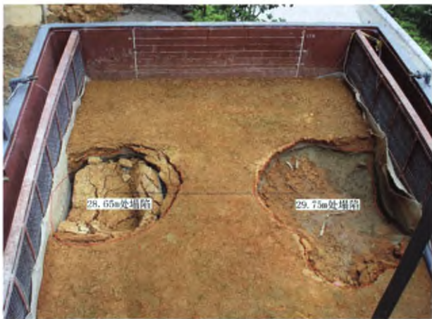
图6 光纤模型试验中形成的岩溶塌陷
