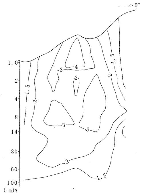
图 3 绿竹坪铅锌矿区 60 勘探线测深  $\eta_s$  等值线断面图
