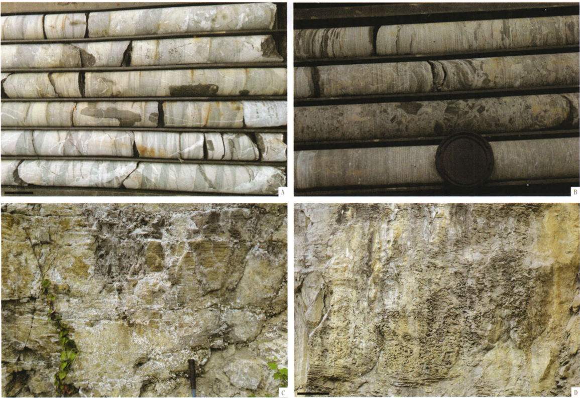
图4 天河板组裂隙及角砾状灰岩——岩芯与露头的对比
