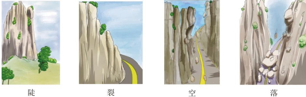
图3 崩塌形成条件示意图
