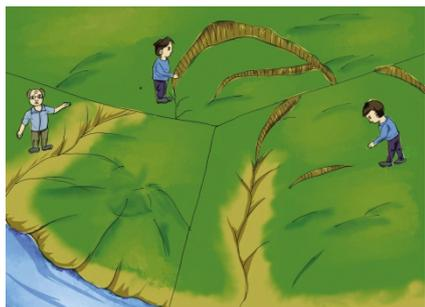
图9 滑坡体的宏观变形
