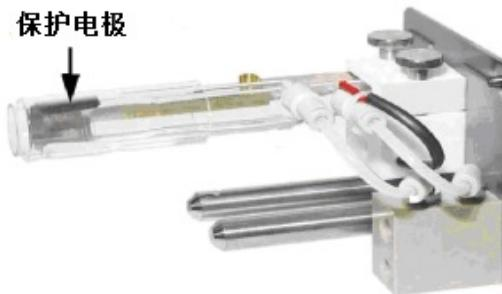
图3 保护电极在炬管中的位置
