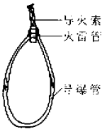
图 1 冲击波相遇叠加实验装置
