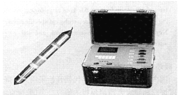
图1 DZ-1型地质灾害土层含水量监测仪
