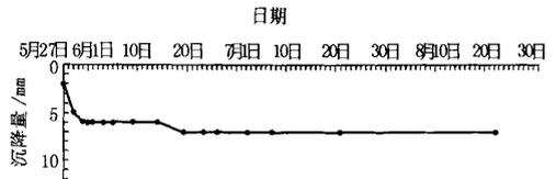
图3 基坑东侧原办公楼沉降监测点铝3变形曲线图
