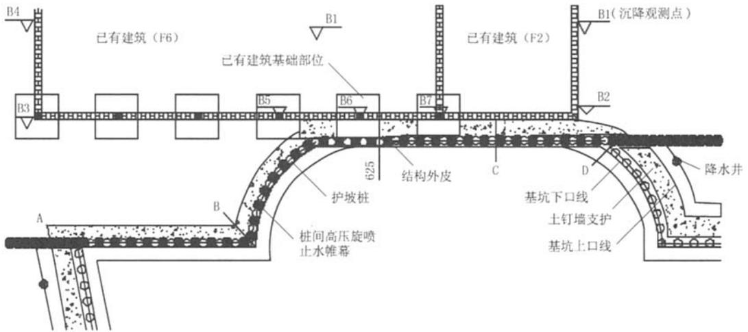
图 1 基坑降水、支护平面布置图
