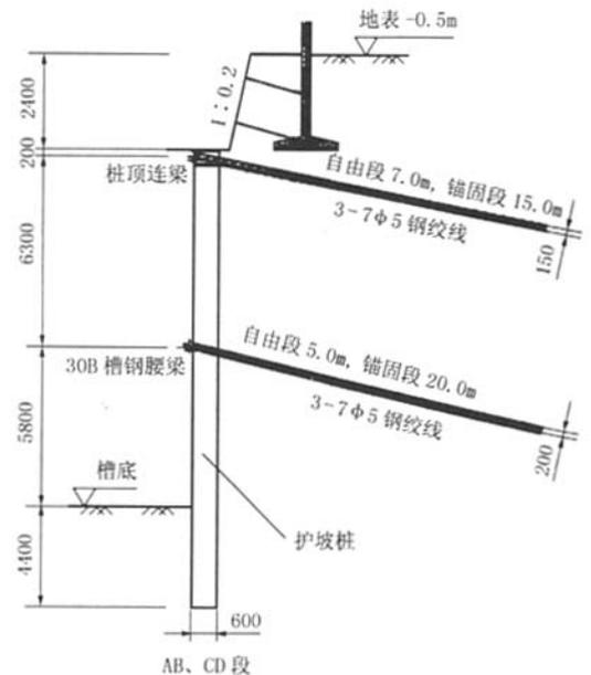
配筋为主筋 12Φ25 均布,加强筋为 Φ16@2000,箍筋为 Ø8@200,桩身混凝土标号为 C25。
